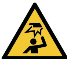
W020 - Pericolo ostacoli in altezza
