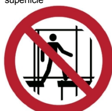
P025 - Divieto di utilizzare un'impalcatura inc.
