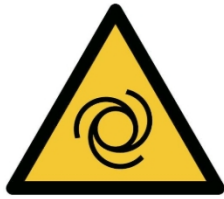
W018 - Pericolo avvio automatico
