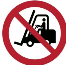
P006 - Vietato l'accesso ai carrelli elevatori a forche e altri veicoli...
