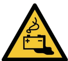
W026 - Pericolo batteria in carica
