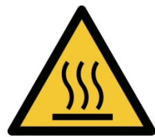
W017 - Pericolo superfici calde
