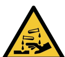
W023 - Pericolo sostanze corrosive
